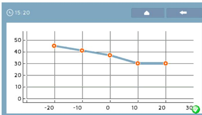
Regulační křivku (ekvitermu) závislou na venkovní teplotě lze upravit přetažením bodů na obrazovce.
