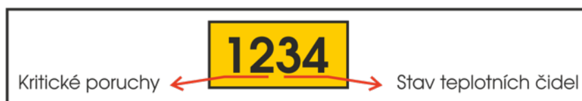
Obrázek 6.1: Dělení poruch a stavů tepelného čerpadla
