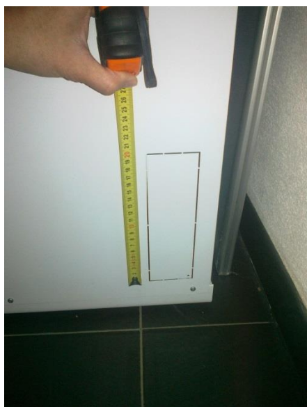
Boční perforovaný prostup (60x200 mm) má odstup hrany prostupu a zadní hrany jednotky 25 mm. Stejné prostupy jsou v levé i pravé boční straně.
