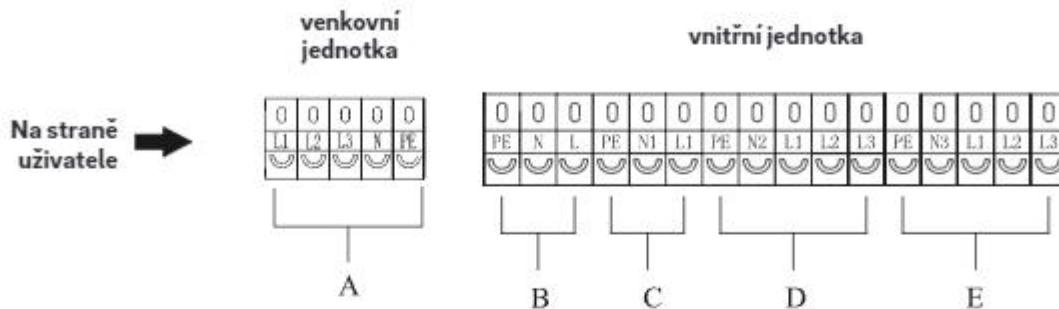
A: Napájení jednotky (napájecí kabel: CYKY 5×2,5 mm<sup>2</sup>) Napájení jednotky.
