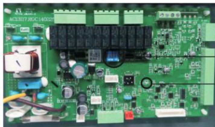
1. Kontrolka LED na vnitřní desce plošných spojů
