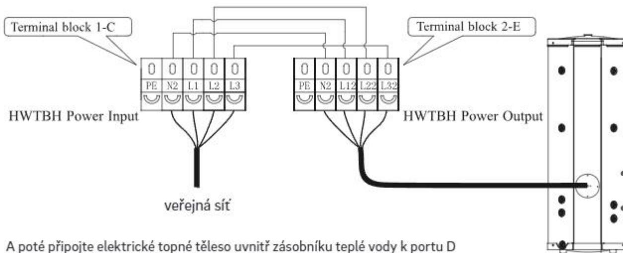
A poté připojte elektrické topné těleso uvnitř zásobníku teplé vody k portu D na svorkovnici 2.
