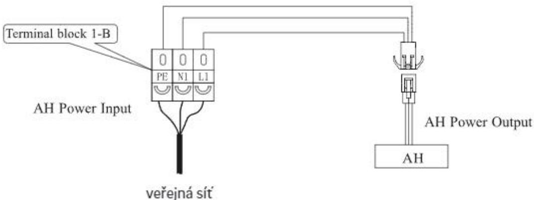
D: Napájení pro HWTBH – záložní ohřívač pro zásobník teplé vody (napájecí kabel: CYKY 2×2,5 mm<sup>2</sup>,
