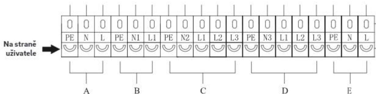
A: Napájení jednotky (napájecí kabel: CYKY 3x2,5 mm<sup>2</sup>)
