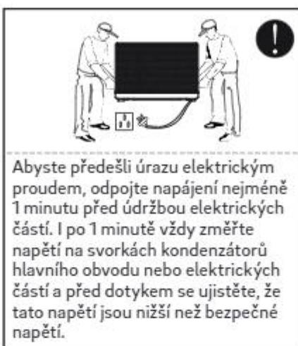
Abyste předešli úrazu elektrickým proudem, odpojte napájení nejméně 1 minutu před údržbou elektrických částí. I po 1 minutě vždy změřte napětí na svorkách kondenzátorů hlavního obvodu nebo elektrických částí a před dotykem se ujistěte, že tato napětí jsou nižší než bezpečné napětí.
