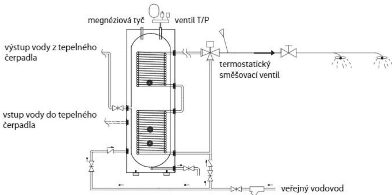
Po připojení tepelného čerpadla přímo k zásobníku se voda z veřejného vodovodu ohřívá horkou vodou v zásobníku, když prochází dlouhou spirálou uvnitř zásobníku.
