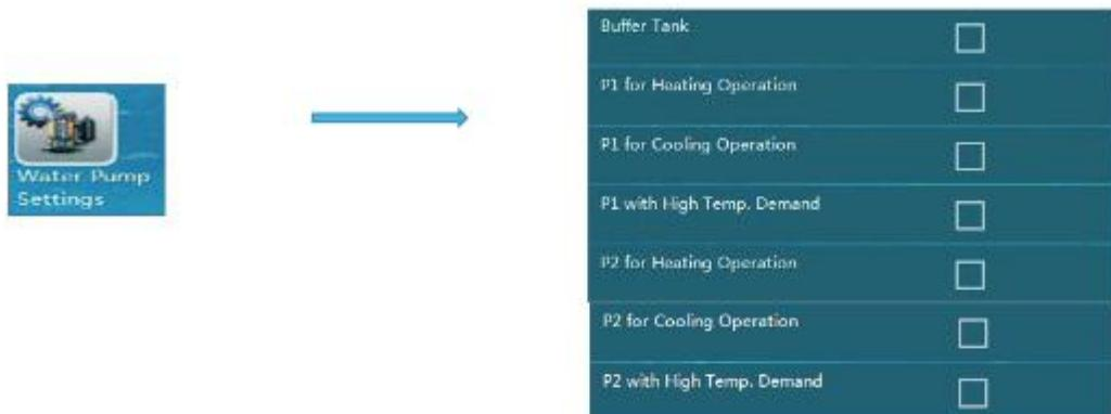
„With/without Buffer Tank“ (s vyrovnávacím zásobníkem / bez vyrovnávacího zásobníku): Nastavte, zda mezi jednotkou tepelného čerpadla a rozvodným systémem je, nebo není vyrovnávací zásobník.
