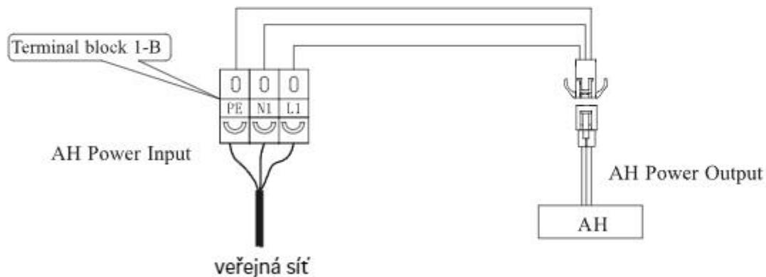
C: Napájení pro HWTBH – elektrické topné těleso (napájecí kabel: CYKY 3x2,5 mm<sup>2</sup>,
