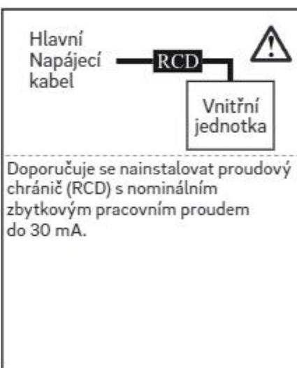
Doporučuje se nainstalovat proudový chránič (RCD) s nominálním zbytkovým pracovním proudem do 30 mA.
