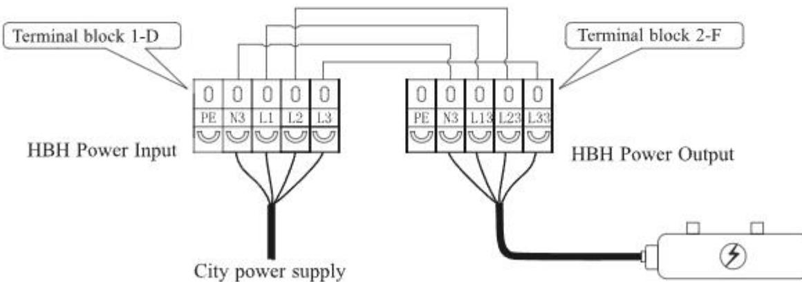
**E: Napájení monoblokové jednotky (napájecí kabel: CYKY 3x2,5 mm<sup>2</sup>, výstup)**
