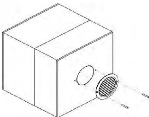
Pokud je povrch fasády hrubý nebo nerovný, doporučujeme aplikovat tmel nebo těsnění na vnitřní stranu plastové mřížky, aby nevznikla mezera mezi mřížkou a fasádou.
