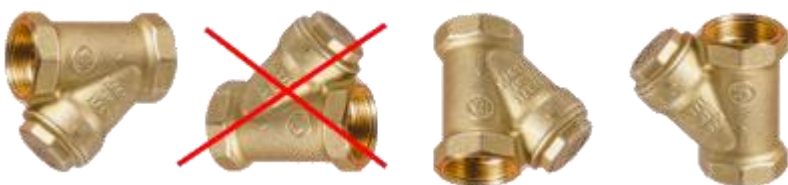
Správné polohy instalace filtru nečistot
