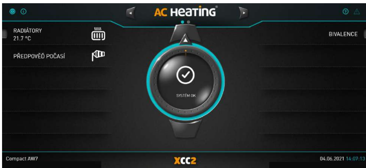
Obr. 24 – úvodní obrazovka při provozu mimo topnou sezonu, zobrazuje jen funkce pro topný okruh s radiátory, bivalentní zdroj a předpověď počasí
