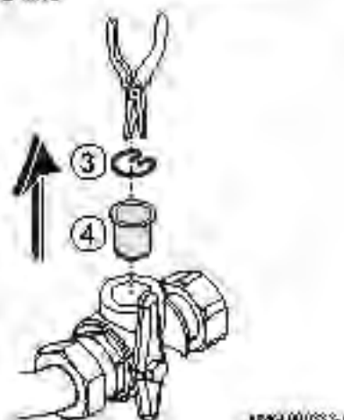
Obr. 55 Demontáž pojistného kroužku a filtru
