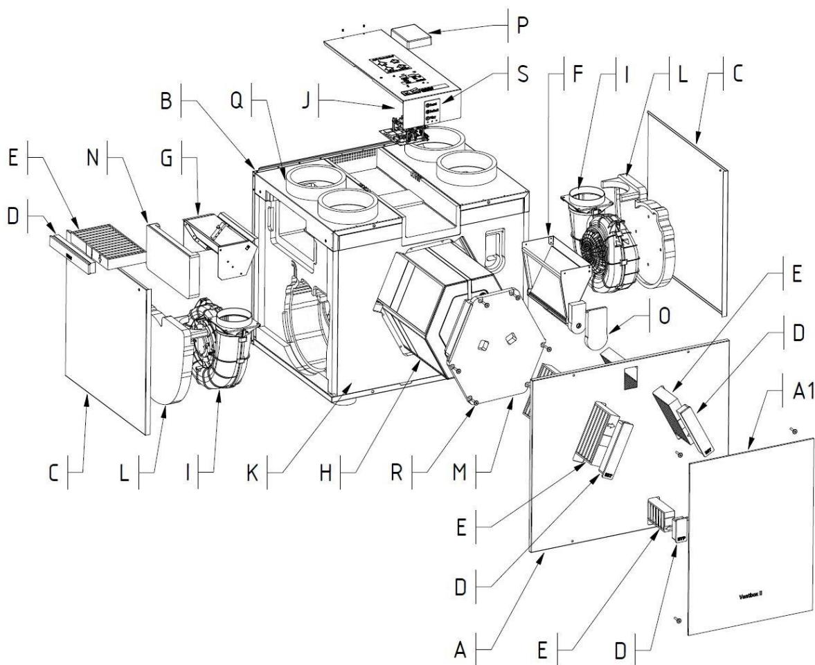
Obrázek 31: Výkres sestavy hlavních částí větracího zařízení
