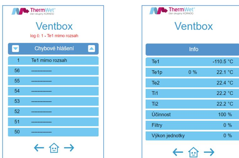
Obrázek 30: Příklad poruchy – Chyba čidla Te1
