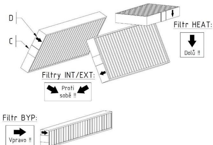
Obrázek 27: Vytahovací páska a směr montáže filtru (LEVÁ varianta)
