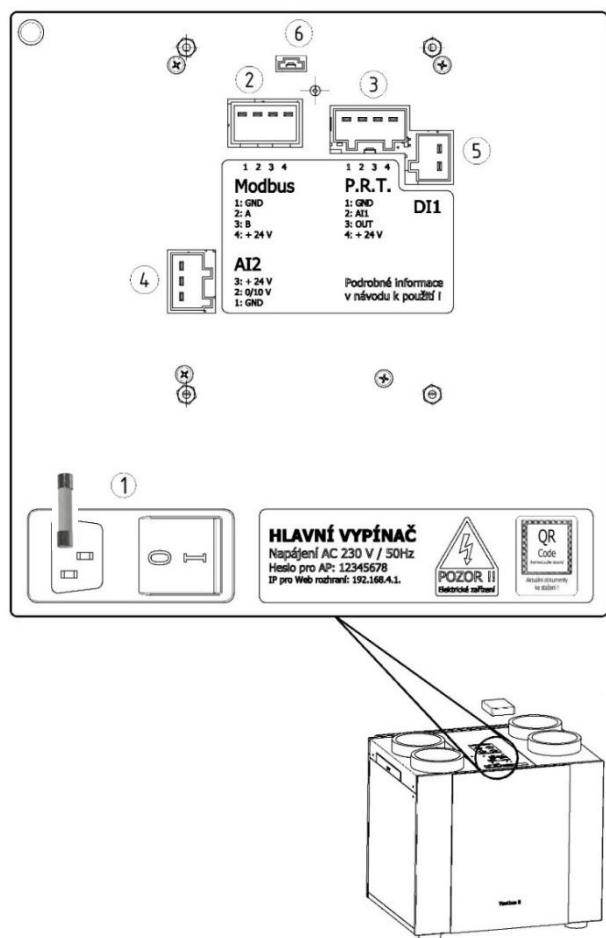
Obrázek 33: Panel řízení s připojením pro konektory
