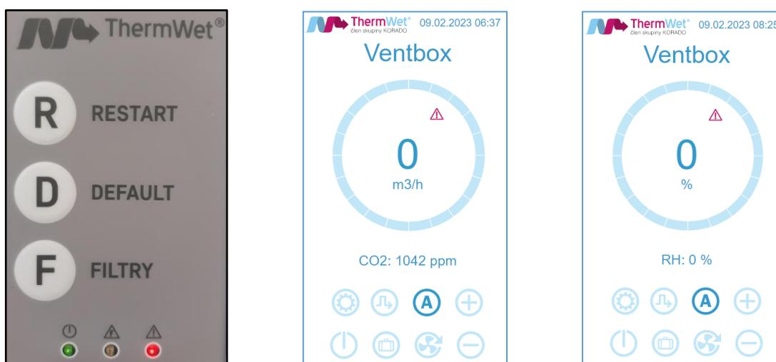
Obrázek 29: Indikace poruchy – ovládací panel / úvodní obrazovka
