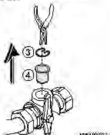
Obr.53 Demontáž pojistného kroužku a filtru
