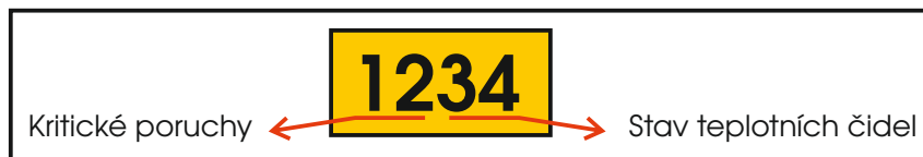
Obr. 16.1 Dělení poruch a stavů tepelného čerpadla
