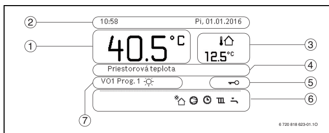
Obr. 5 Symboly pri štandardnom zobrazení (príklad zobrazenia na displeji)
