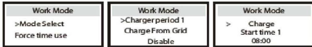
Legenda: Work Mode=Provozní mód; Mode Select=Vybrat mód; Force time use=časový plán; Charger period=doba nabíjení; Charge from grid=Nabíjet ze sítě; Disable=Vypnout; Charge=Nabíjet; Start time=Začátek.
