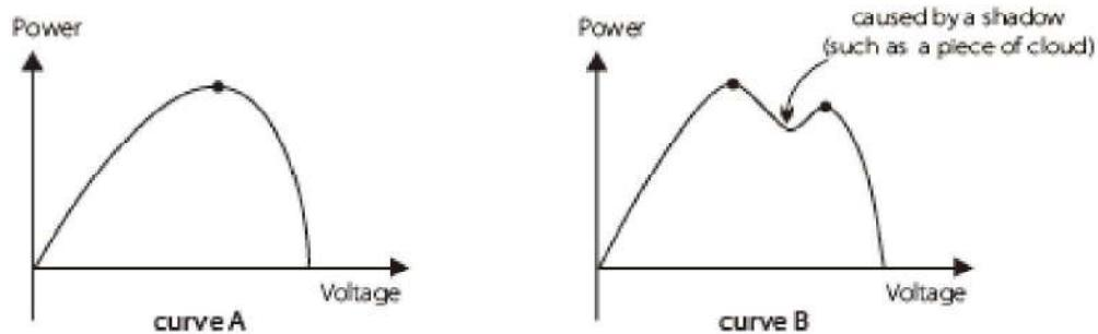
Legenda: Power=Energie; Curve=Křivka; Voltage=Napětí; caused by a shadow...= Způsobeno stínem (jako třeba mrakem).
