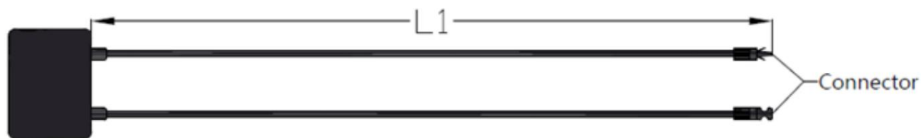
Obr. 12 (1) Celočláňková spojovací skříňka modulu
