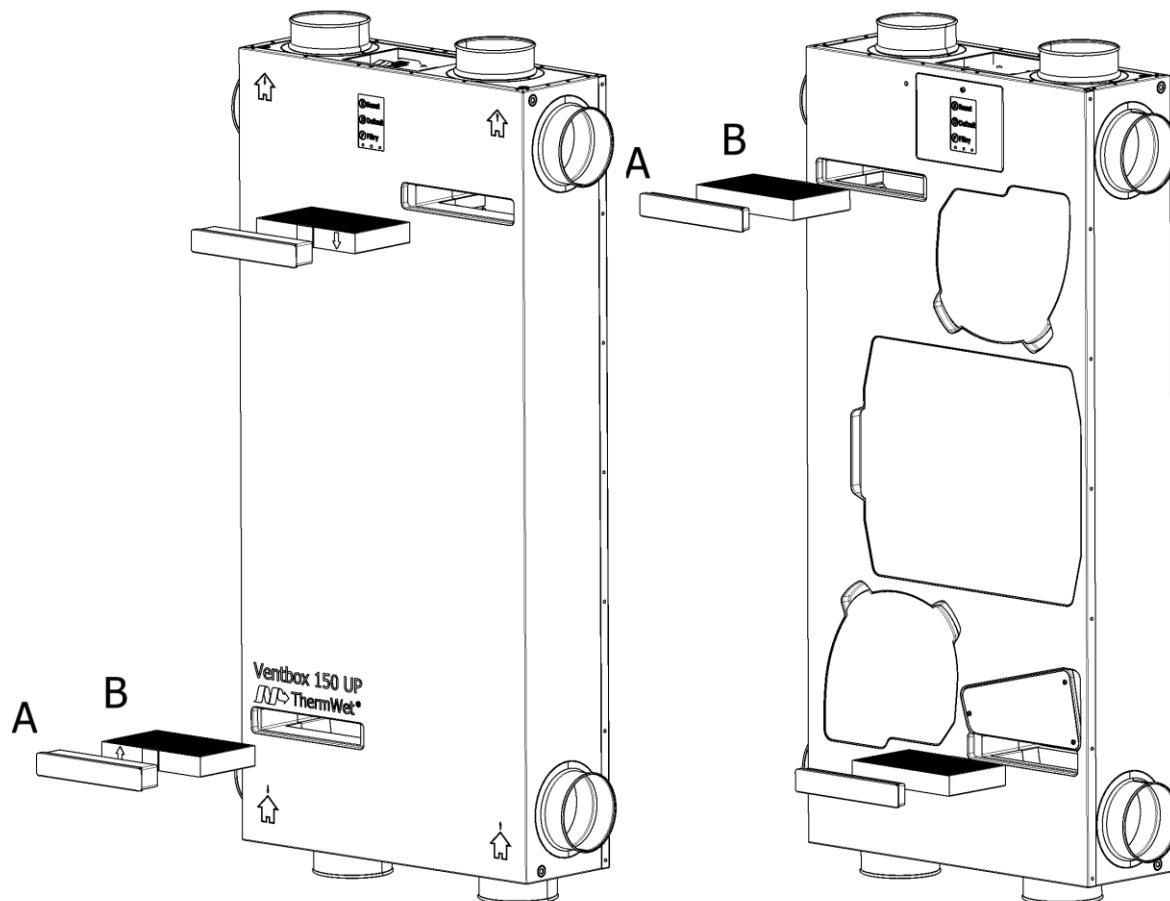
Obrázek 26: Vyjmutí filtru (LEVÁ / PRAVÁ varianta)
