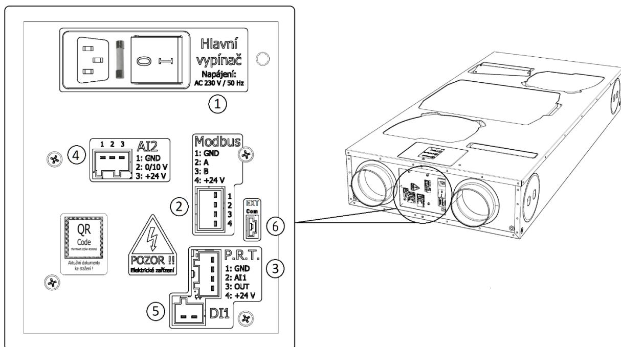
Obrázek 36: Panel řízení s připojením pro konektory
