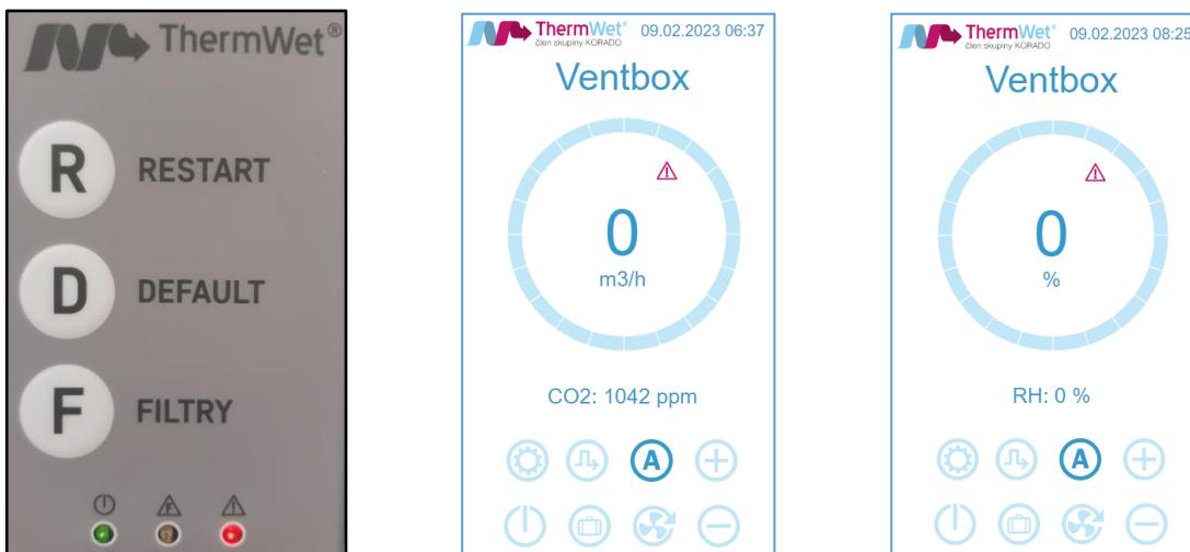
Obrázek 28: Indikace poruchy – ovládací panel / úvodní obrazovka
