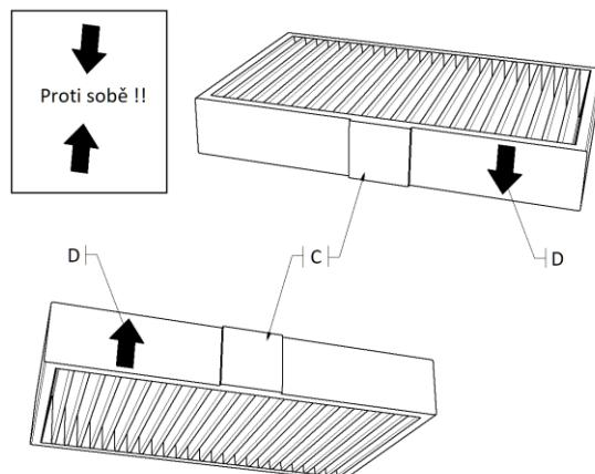
Obrázek 27: Vytahovací páiska a směr montáže filtru
