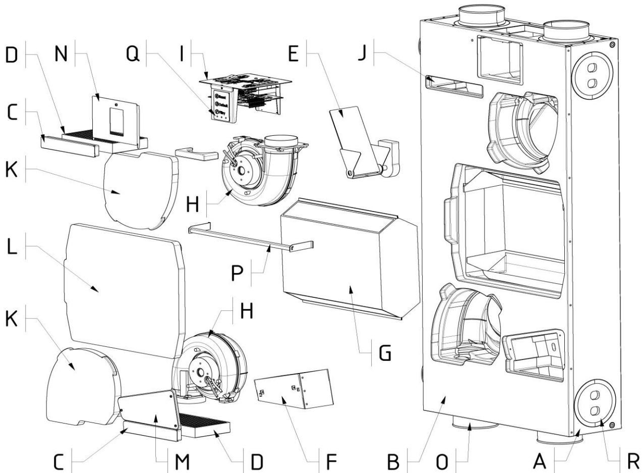
Obrázek 31: Výkres sestavy hlavních částí větracího zařízení
