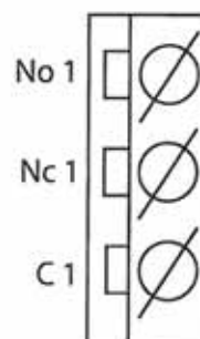
Detail svorkovnice pro alarm.
