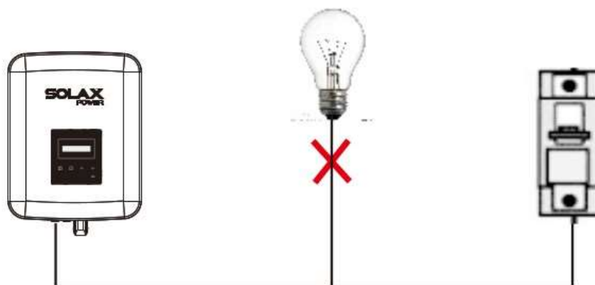
Nesprávné připojení spotřebičů k měniči
