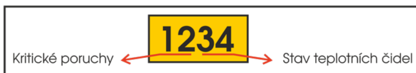
Obrázek 7.1: Dělení poruch a stavů tepelného čerpadla
